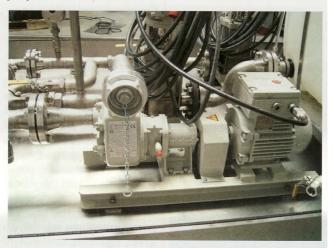
rem im Bereich der Hydraulik überarbeitet. Somit ist ein besserer Wirkungsgrad dieser Serie erzielt worden. Des Weiteren wurden Modifikationen im Bereich der Blockpumpen nach einer langen und ausgiebigen Testphase freigegeben. Jetzt können Blockpumpen auch mit Normmotor und Steckwelle geliefert werden. Dies hat den Vorteil, dass bei einem Motorausfall jeder handelsübliche Motor eingesetzt werden kann, ohne auf längere Lieferzeiten der Motoren mit Sonderwellen angewiesen zu sein.
